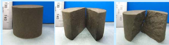
亀裂なし 亀裂(カッター面) 亀裂(一軸破壊試験)
